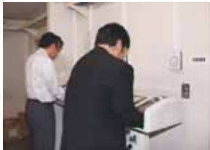
ハンドフットクロスモニターによる退出時の汚染検査
