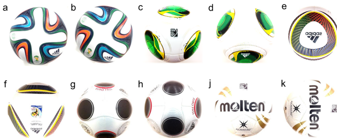
図1. 本実験で使用したサッカーボールとパネル向きの設定: (a, b) Adidas Brazuca, (c, d) Adidas Cafusa, (e, f) Adidas Jabulani, (g, h) Adidas Teamgeist 2, (i, j) Molten Vantaggio (conventional soccer ball).
