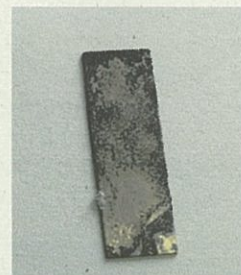
図 12 Mg 板表面の様子 (0.030M EDTA)
