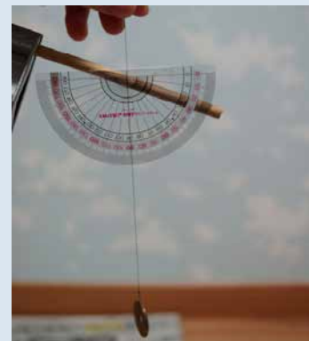
② 分度器で傾きを測る
