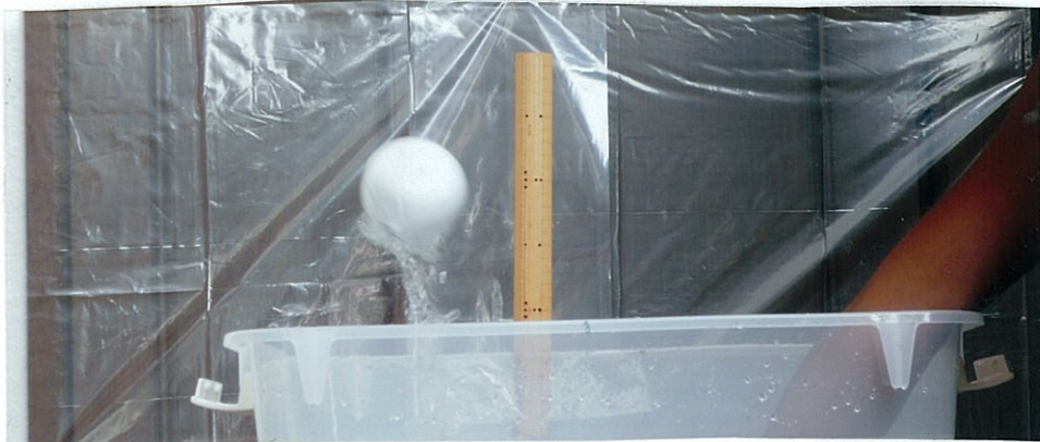
左の写真は直径70mmのボールが飛んでいる時の様子 20cmをこえているのが分かる。
