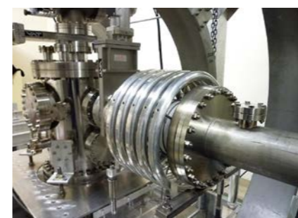
陽電子消滅を用いた材料評価装置。国内外のさまざまな企業・研究機関と共同研究を進めている。
