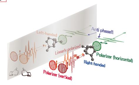
本実験の概略図。直線偏光(縦偏光)のレーザー光(そのうちーつは白色レーザー)を試料に 照射すると、分子のキラリティに依存して、異なるスペクトル形を持つ横偏光の信号光 (CARS-ROA 光)が発生する。右型と左型の分子では、そのスペクトルは正負逆のスペクトル 形状を示す。
