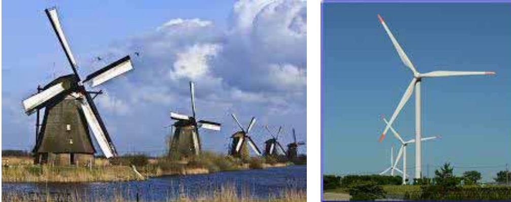
図3. (左) 伝統的風車（オランダ型），（右）風力発電用風車（プロペラ型）
